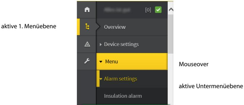
Die Menüstruktur wird vom jeweilig angewählten Gerät generiert. Sie unterscheidet sich je nach Gerät und von der Struktur dessen Gerätemenü. Die Struktur der Gerätemenü ist in den Handbüchern der Gerätevarianten im Kapitel „Einstellungen“ dargestellt.
