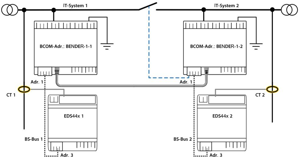
Jedes ISOMETER® iso685-x-P verwaltet seine EDS und sendet seinen EDS die für die Isolationsfehlersuche notwendigen Triggersignale über seinen BS- und BB-Bus. Damit in gekoppelten Netzen auch EDS, die an andere iso685-x-P angeschlossen sind, Triggersignale empfangen, muss die Funktion EDSsync aktiviert werden.
