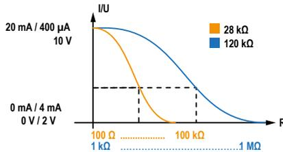
Berechnung des Isolationswiderstandes über den Analogausgang:
