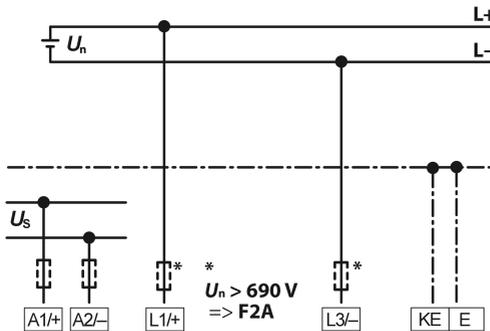
**i** Bei Systemen mit einer Netznominalspannung von über 690 V und Überspannungskategorie III ist eine Sicherung für den Anschluss an das zu überwachende Netz vorzusehen. \* 2-A-Sicherungen empfohlen.
