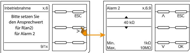
Nachdem Sie den Ansprechwert  $R_{an2}$  für Alarm 2 eingestellt haben, startet das Gerät einen Selbsttest, danach die initiale Messung und anschließend die Ausgabe des ermittelten Isolationswiderstandes des überwachten IT-Systems und die Inbetriebnahme ist abgeschlossen.
