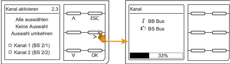
3. Prüfen Sie, ob der maximale Prüfstrom zum EDS korrekt ist. Passen Sie ihn gegebenenfalls an. Warten Sie, bis der Prozess abgeschlossen ist. Siehe „Strom“, Seite 61.
